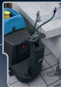
FFF (FimapFastFill) un système de double tuyau permet de remplir le réservoir solution et de nettoyer le réservoir de récupération, facilement et rapidement.
