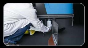
La position du filtre à huile hydraulique (de 10 microns)
